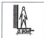
\*Le passage minimum nécessaire pour un seul piéton est de 90cm, ce qui correspond à une unité de passage en terme de sécurité incendie (calcul de la largeur des escaliers et issues de secours)
