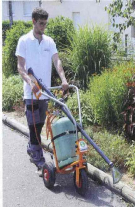
la lance thermique qui, tout en restant mobile, permet de désherber sans effort sur une largeur pouvant atteindre 40 cm. En montée, deux opérateurs peuvent se répartir les fonctions de conduite du chariot et du désherbage à la lance. D'après l'entreprise, le système permettrait à un seul opérateur de traiter jusqu'à 500 m<sup>2</sup>/h.
