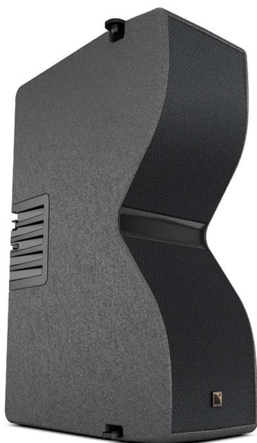
Le Kiva II est un système de ligne source modulaire WST® ultra-compact conçu pour les applications de sonorisation à longue portée avec impact visuel minimal. Le Kiva II comprend deux haut-parleurs de 6,5" logés dans une enceinte bass-reflex et un moteur de compression à membrane de 1,75" chargé par un guide d'ondes DOSC et des L-Fins.
