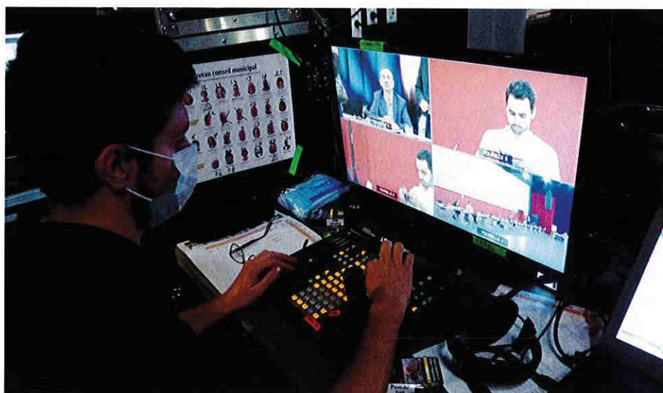
Le choix des plans des quatre caméras se réalise en télécommande. Chaque technicien dispose d'un trombinoscope avec le nom des élus présents et le numéro qui leur est attribué.
