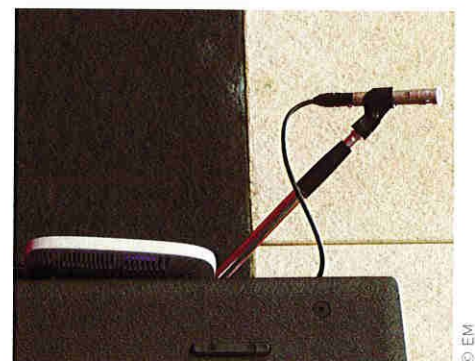
Posée dans un angle de la salle, la borne Shure MXCWAPT assure la réception de tous les signaux des postes, alors que le micro capte l'ambiance du lieu pour aérer le mixage son.
